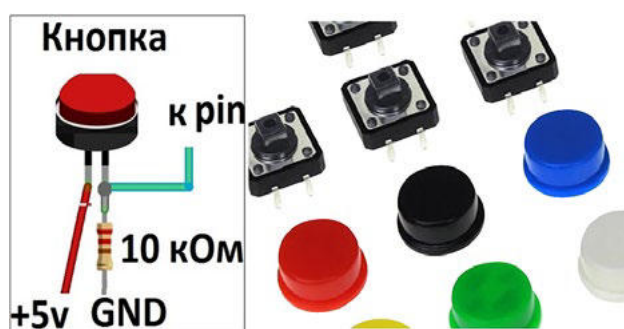
Рис. 1. Схема подключения тактовой кнопки к микроконтроллерной плате
