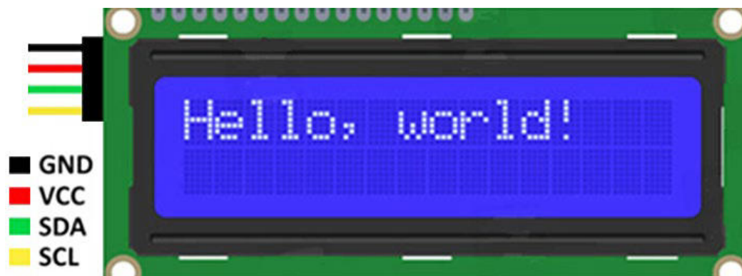
Рис. 1. Подключение модуля ЖКИ к Ардуино
